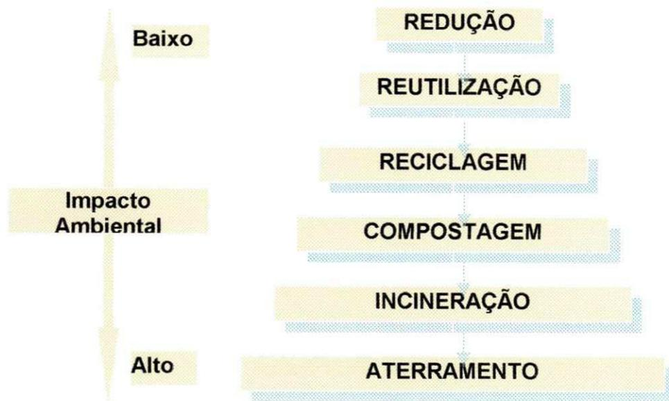
Figura II – Hierarquia da disposição de resíduos de construção e demolição
