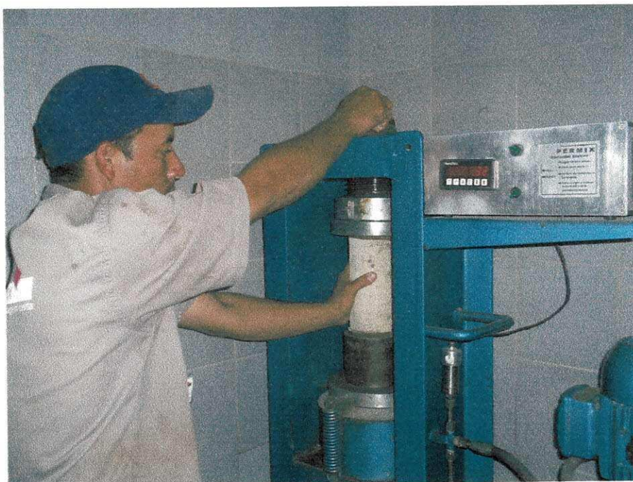
Rompimento dos Corpos-de-prova de modo automatizado
