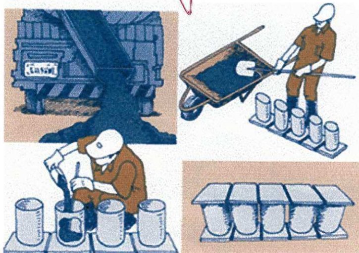
Procedimento da Moldagem dos Corpos-de-Prova na Obra
