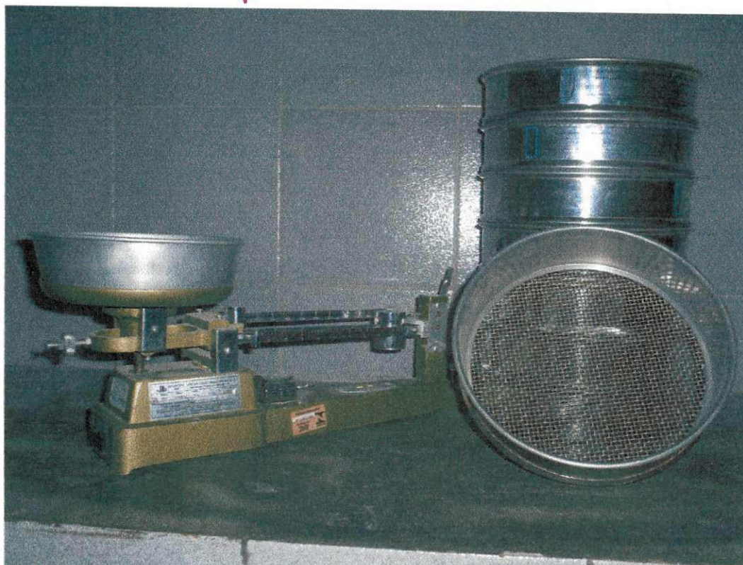
Instrumentos para ensaio de granulometria (Peneiras e Balança)
