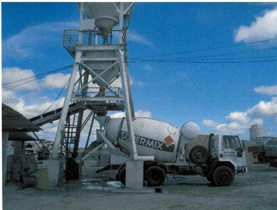
Carregamento do Caminhão Betoneira
