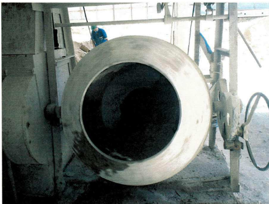
Figura 06- Betoneira utilizada na Obra para preparo da Argamassa.
