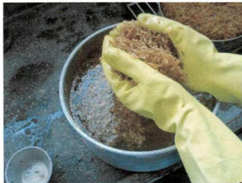
Figura 5 – Casca de arroz utilizada nas moldagens dos corpos de prova.
