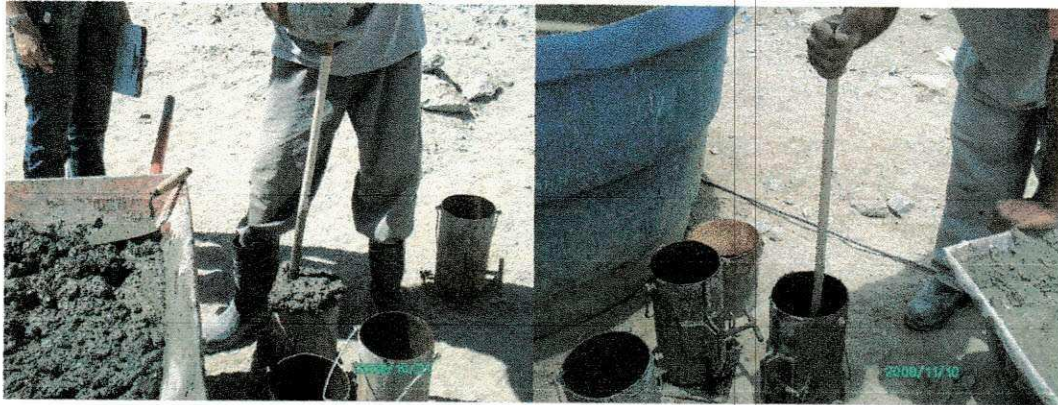
Figura 6 – Produção de corpos de prova de concreto
