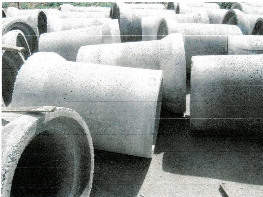
FIGURA 6: Tubos de concreto para drenagem (fonte: Arquivo, Andrade Galvão).
