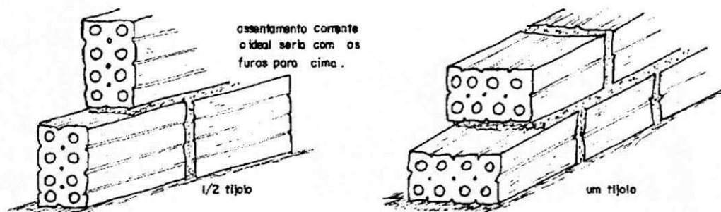
Figura 17- Levantamento de Paredes com Tijolos Furados
