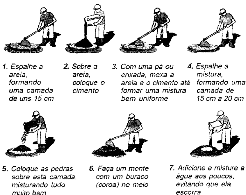
Figura 28- Mistura Manual do Concreto
