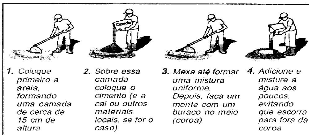
Figura 33- Preparo Manual da Argamassa
