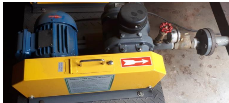
Figura 4.4 – Equipamento soprador de fontes de três lóbulos
