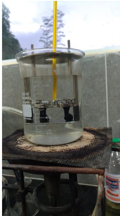
Figura 12: Execução do ponto de amolecimento
