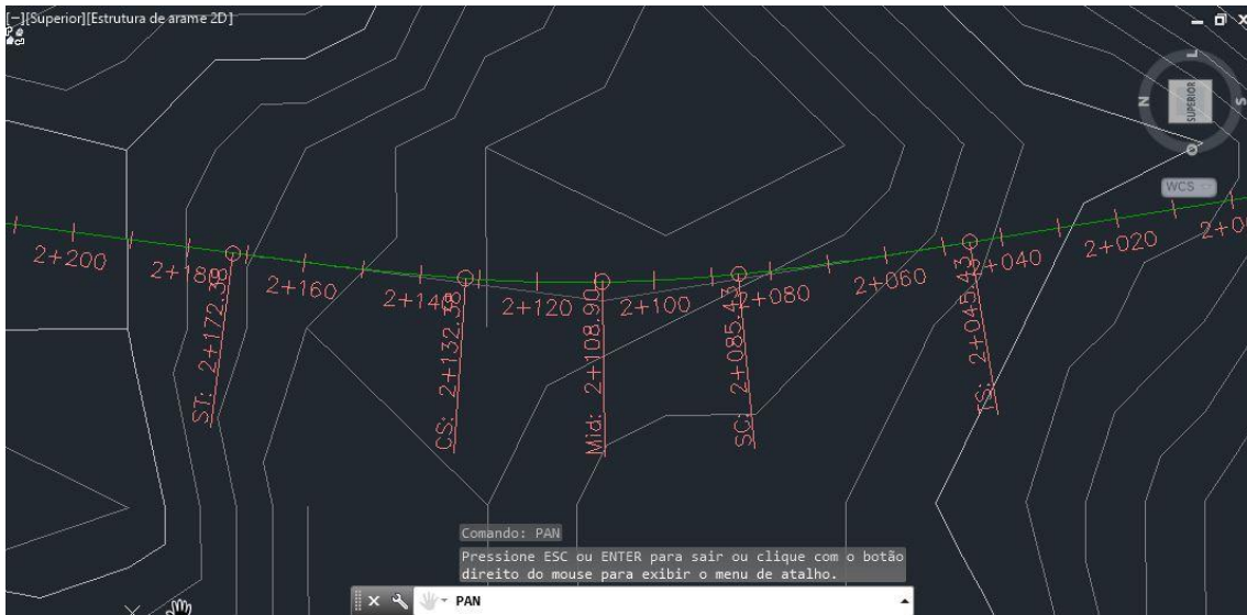
Figura 35: Detalhe da curva horizontal
