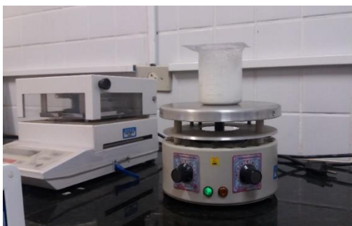
Figura 9 – Procedimento de agitação magnética das nanopartículas.
