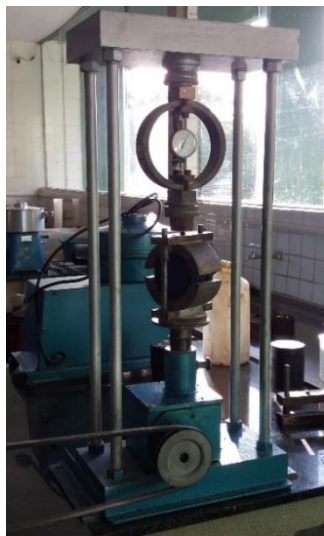
Figura 18 – Execução do ensaio de estabilidade Marshall.
