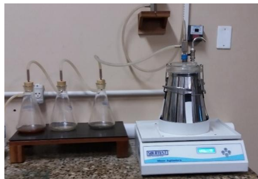
Figura 16 - Execução do Rice Test.
