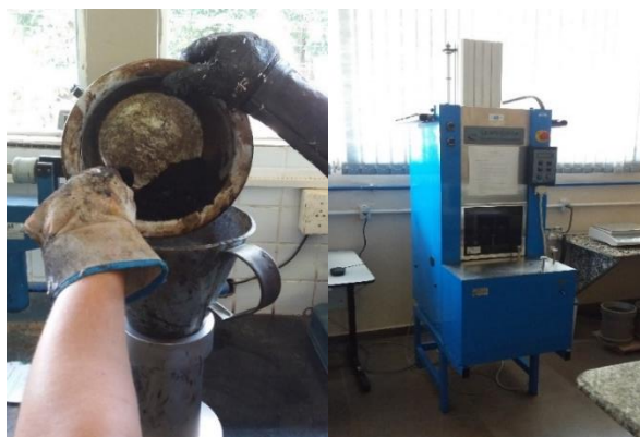
Figura 14 – Etapas da compactação das misturas avaliadas.
