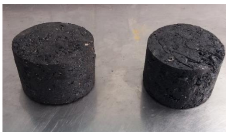
Figura 19 – Aspecto do corpo de prova após a ruptura.
