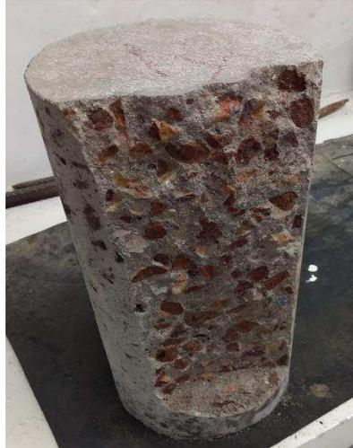
**Figura 19:** Ruptura dos agregados
