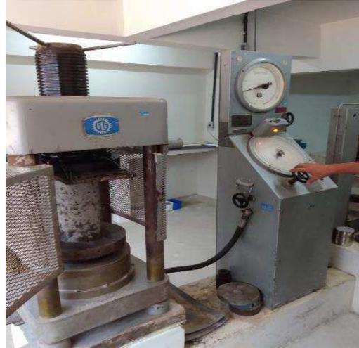
**Figura 17:** Prensa de ruptura à compressão
