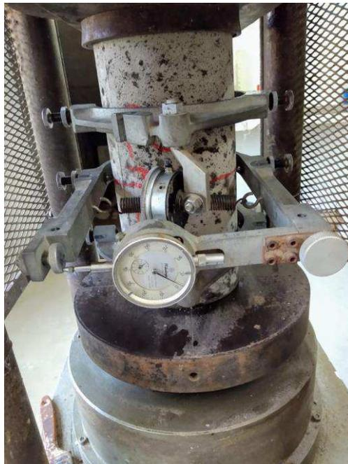
**Figura 22:** Compressômetro-expansômetro mecânico
