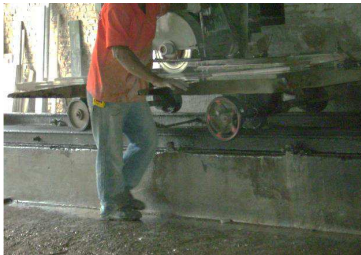
Figura 5 - Corte das chapas de granito e mármore
