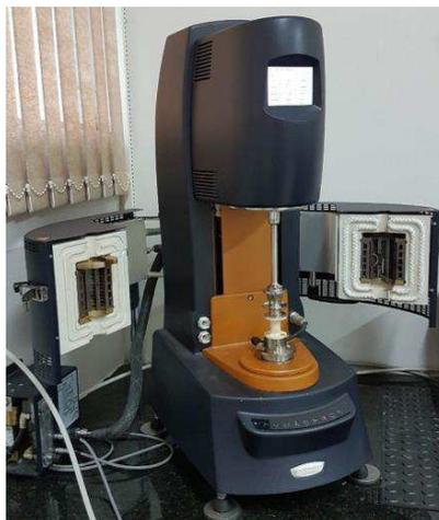
O Módulo Complexo ( $G^*$ ) é definido pela razão do máximo de tensão aplicada/máximo de deformação, ou seja, está relacionado com a quantidade de resistência do asfalto quando submetido por cargas. Os vetores comprovam, observando que quanto maiores o Módulo Elástico ( $G'$ ) e o Módulo Viscoso ( $G''$ ), maior será a resultante, o Módulo Complexo.
