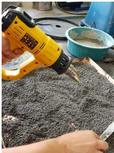
Figura 16 - Secagem superficial do pó de pedra.
