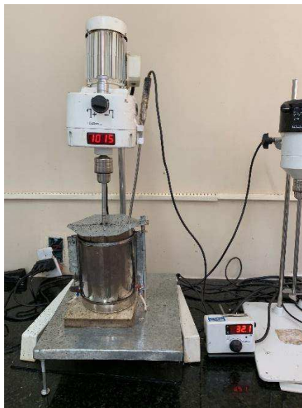
Figura 17 - Procedimento de mistura do CAP com cera.
