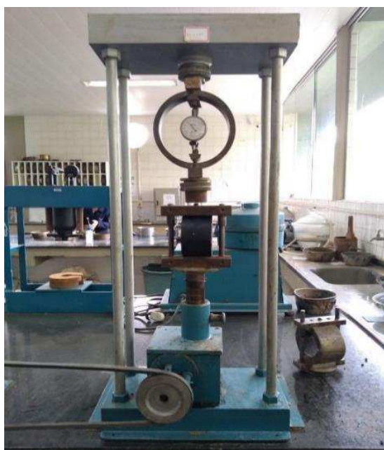
Figura 13 - Execução do RT.
