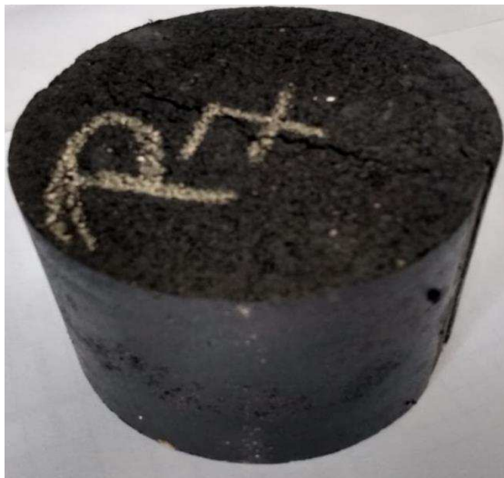
Figura 14 - Corpo de prova após execução do RT.
