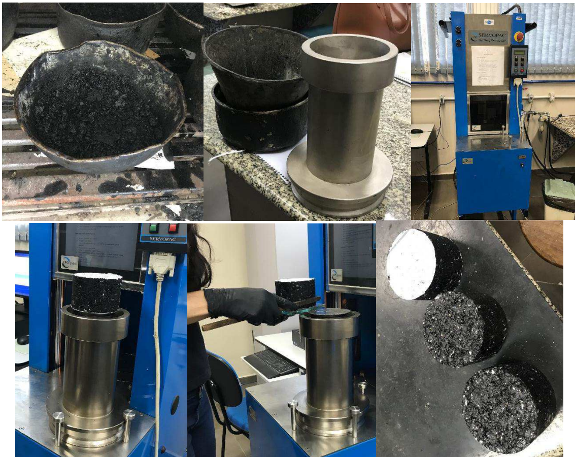
Figura 14 - Compactação dos corpos de prova a partir do SUPERPAVE
