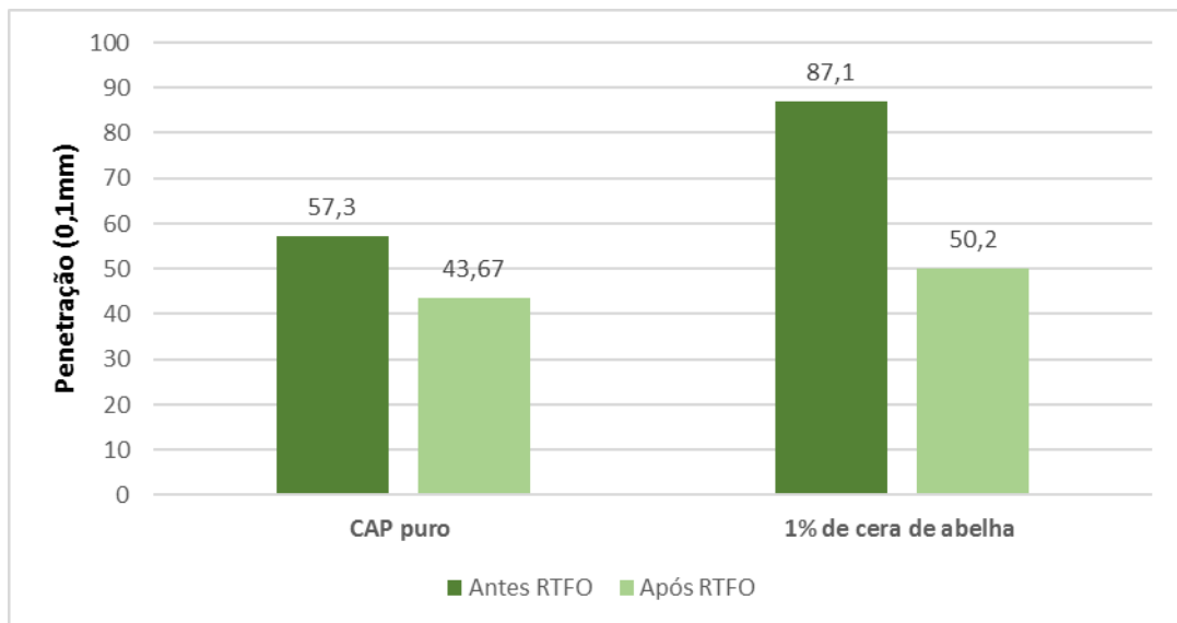
Figura 16 - Resultados do ensaio de penetração (Antes e após RTFO)
