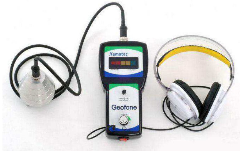
Figura 3: Geofone eletrônico analógico.
