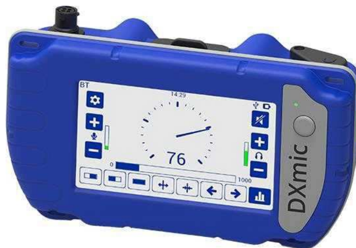
Figura 4: Geofone eletrônico digital.
