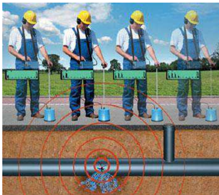
Figura 5: Utilização do geofone na escuta dos vazamentos de água.
