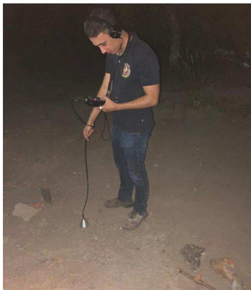
Figura 20: Utilização do geofone à noite
