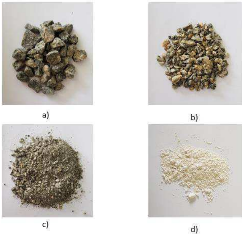
Figura 5 - Amostra de (a) brita 19, (b) brita 9,5, (c) pó de pedra e (d) cal hidratada
