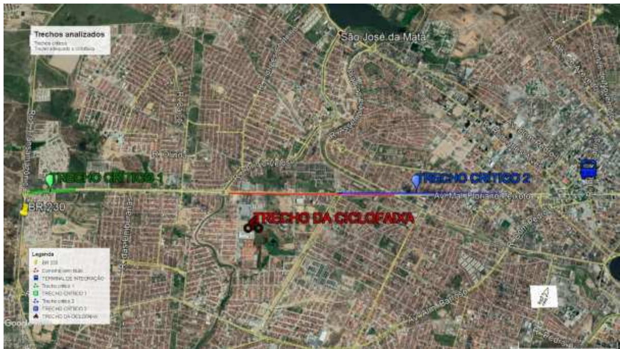
Figura 9: Trechos críticos e sugestão de trecho de Implantação da ciclofaixa
