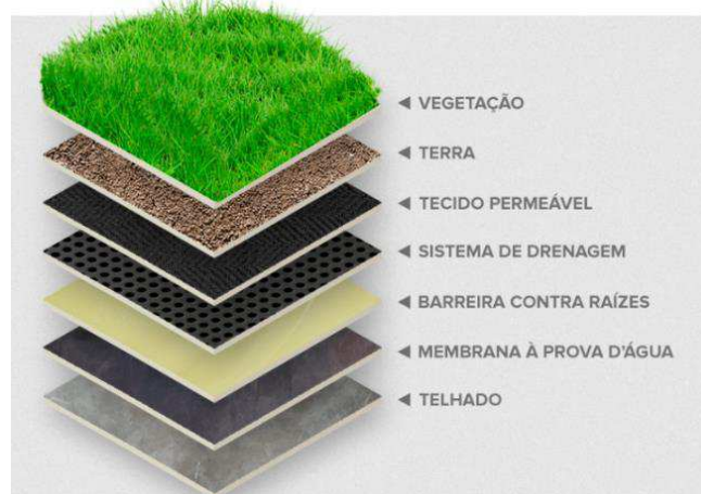
Figura 16- Camadas do telhado verde
