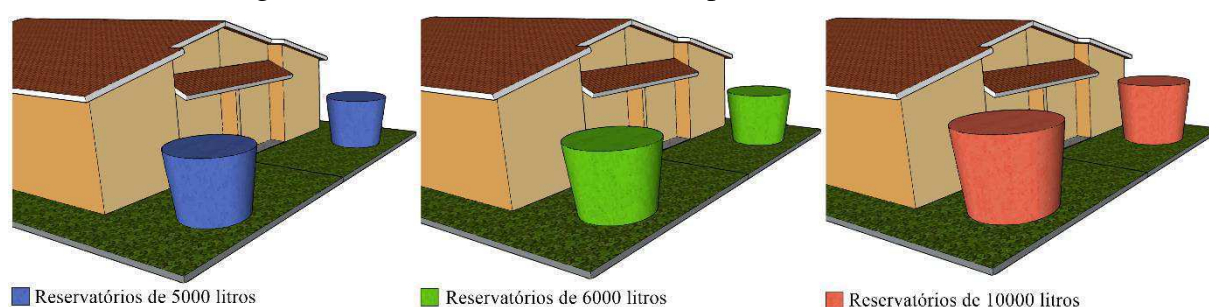
Figura 17. Vista dos reservatórios dispostos nas residências.
