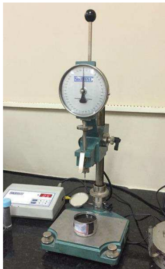
Figura 10: Aparelho utilizado para realização do ensaio de penetração.
