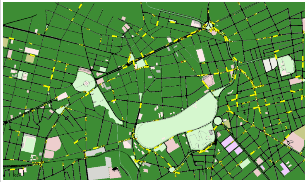
Figura 4.3: Modelo de mobilidade de parte da cidade de Campina Grande, visto pelo Sumo.
