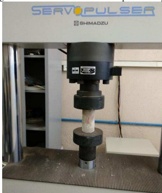
Figura 15 - Ensaio de resistência à compressão simples
