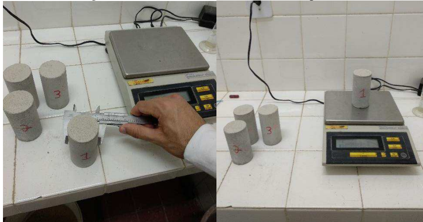
Figura 16 - Ensaio de densidade de massa aparente
