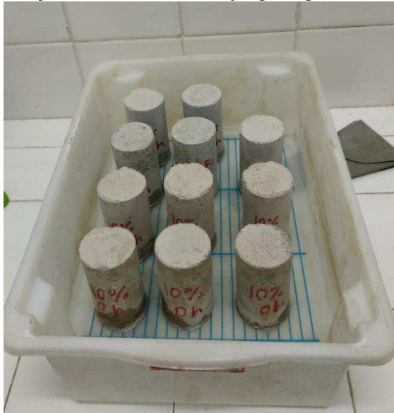
Figura 17 - Ensaio de absorção por capilaridade
