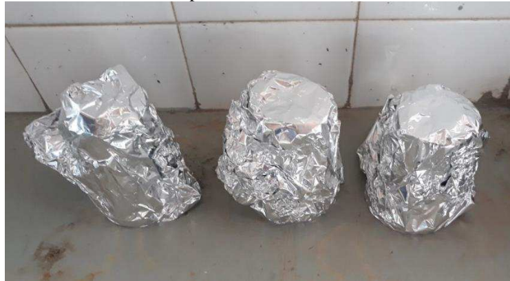
Figura 5 - Envolvimento dos moldes e corpos de prova com papel alumínio para determinação da atividade pozolânica com cal
