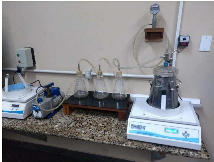
Figura 12 – Rice Test em execução
