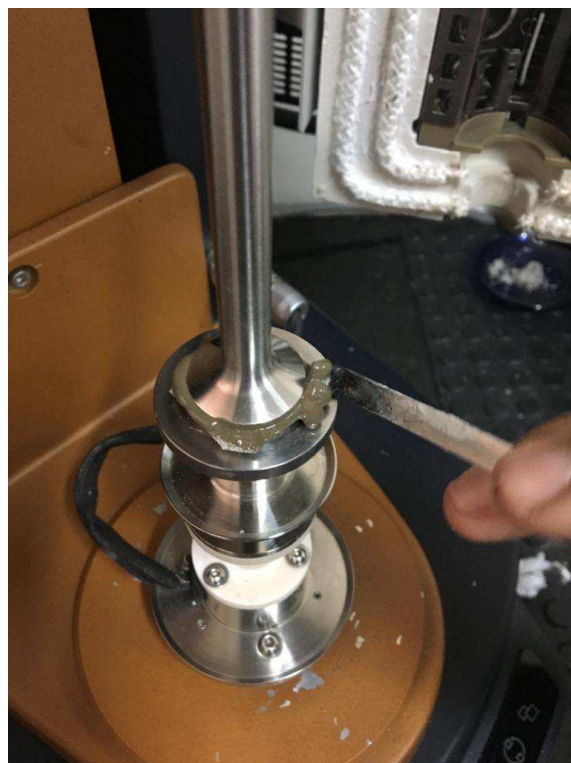
Figura 17: Excesso da amostra sendo retirado
