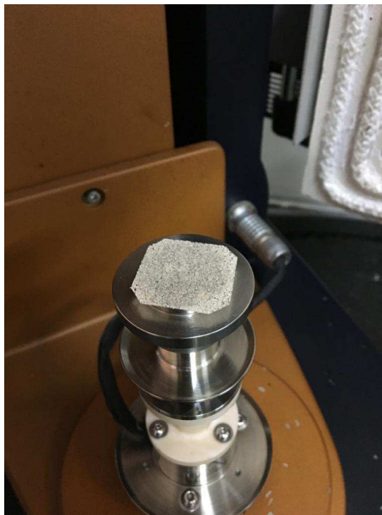
Figura 15: Revestimento texturizado nas placas
