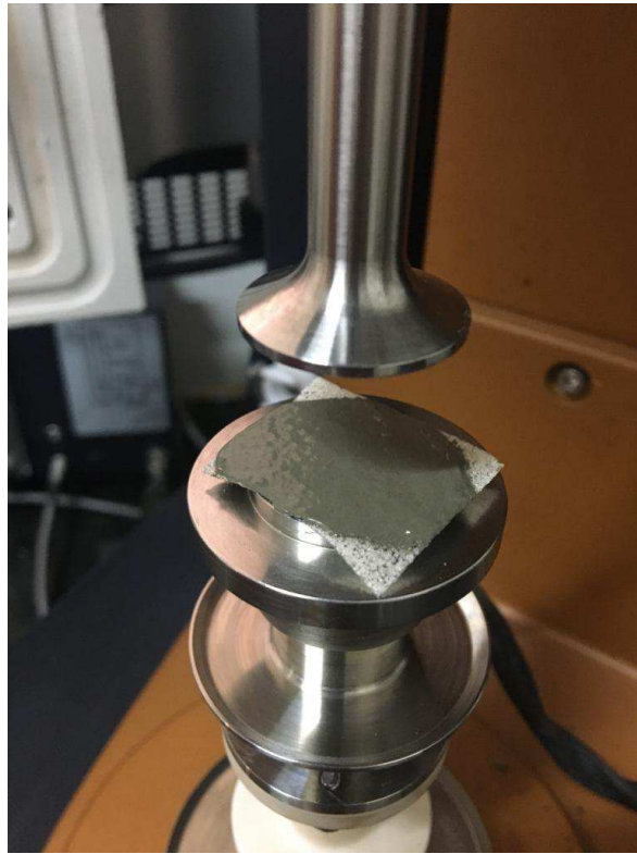
Figura 16: Acomodação da amostra em cima da fita adesiva
