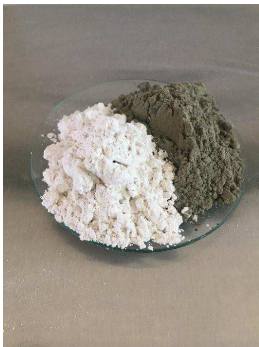
Figura 9: Pesagem de 80% de cimento e 20% de MC tipo II calcinado
