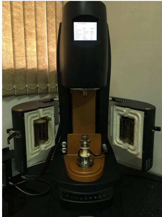
Figura 14: Reômetro rotacional de placas paralelas
