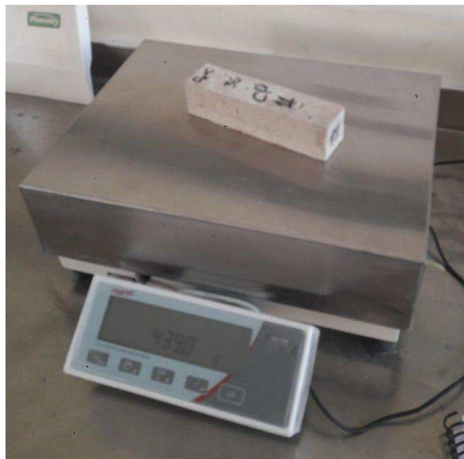
Figura 22 - Peso da massa seca do corpo-de-prova prismático para determinação da densidade de massa endurecida (ou aparente).
