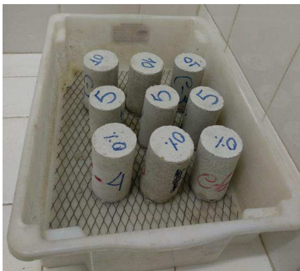
Figura 7: Ensaio de absorção por capilaridade.
