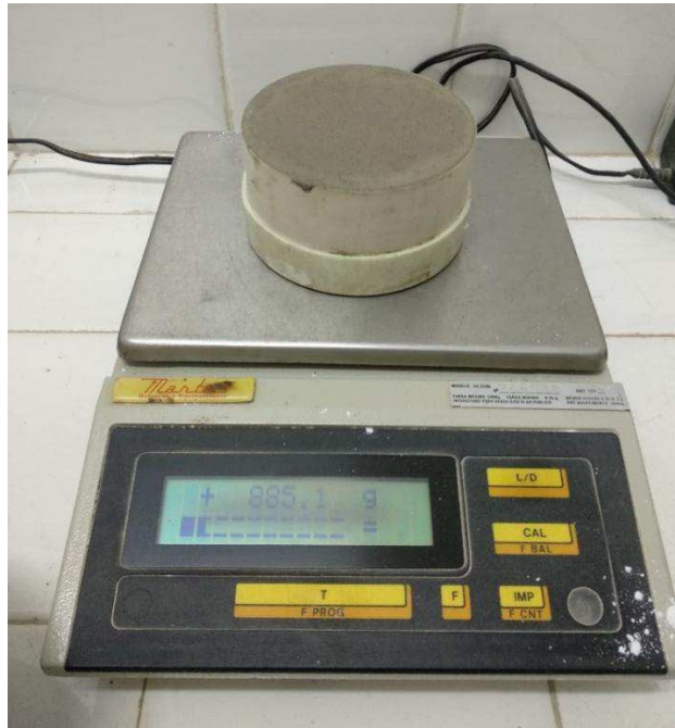
Figura 6: Ensaio de densidade de massa.
