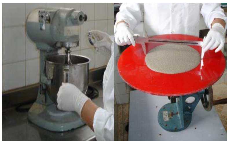
Figura 5: Etapas do ensaio da mesa de consistência.
