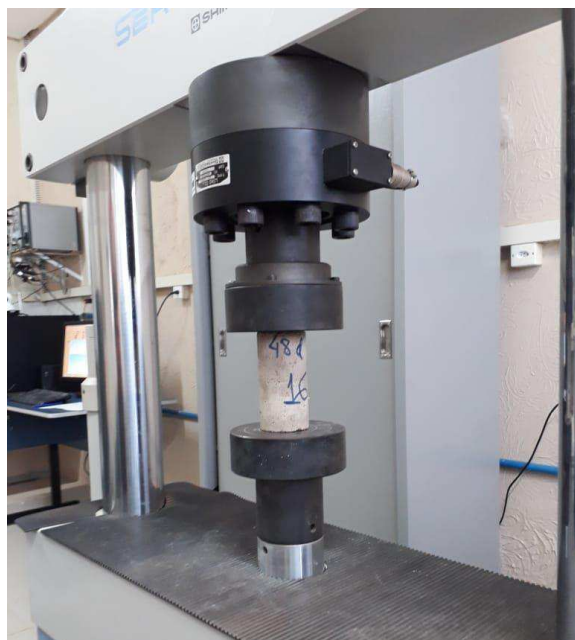
Figura 8: Ensaio de Resistência à Compressão Axial.
