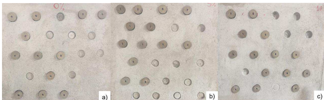
Figura 7: Cortes circulares utilizados no arrancamento dos corpos de prova: a) argamassa de referência; b) argamassa com 5% da areia substituída por PET; c) argamassa com 10% da areia substituída por PET.
