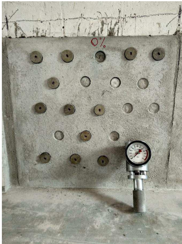
Figura 9: Visor do dinamômetro manual utilizado para leitura da tensão de tração aplicada nos corpos de prova.
