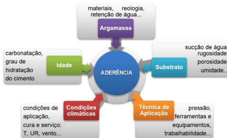
Figura 2: Fatores que influenciam na aderência das argamassas sobre os substratos.
