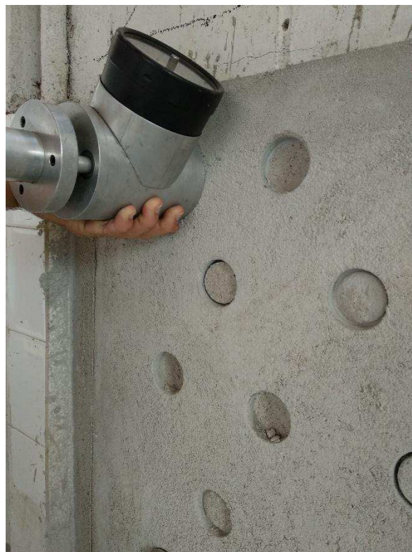
Figura 8: Aplicação da tensão de tração nos corpos de prova com o dinamômetro manual.
