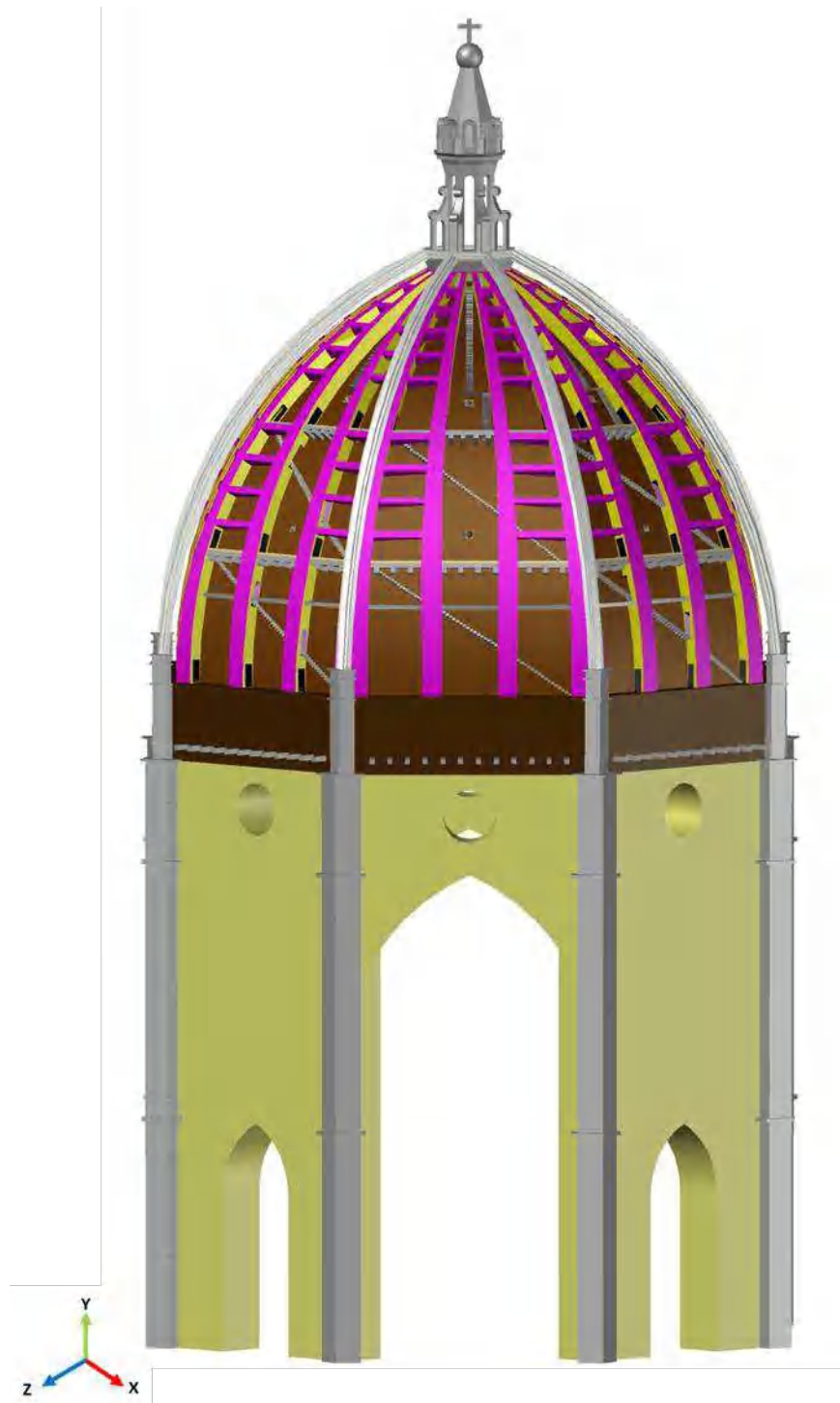
Figura 78: Modelo tridimensional da Cúpula de Brunelleschi: modelo completo com detalhes dos elementos internos.
