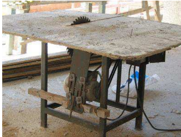
Figura 7 - Serra elétrica sem nenhum dispositivo de proteção
