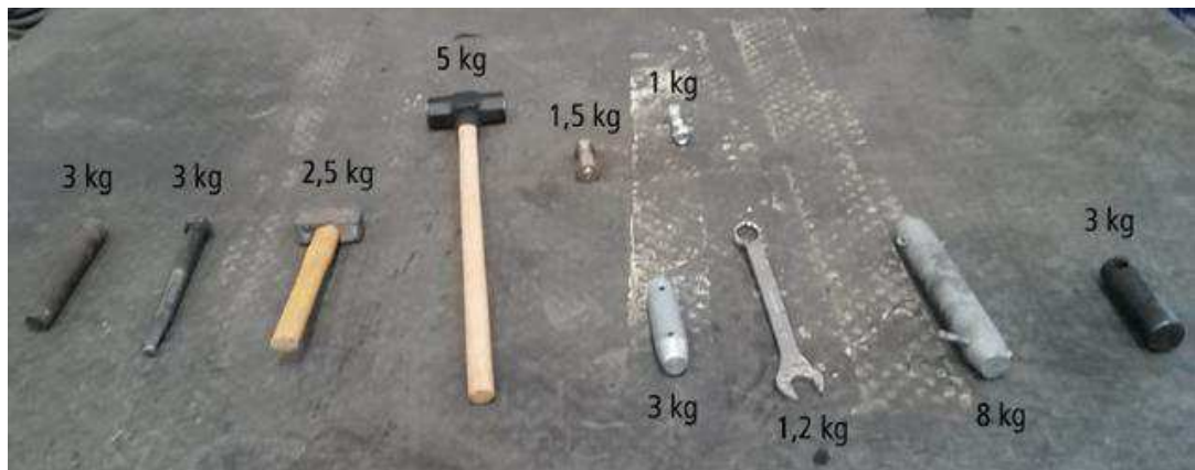
Figura 5 - Peso de ferramentas utilizadas por trabalhadores em grandes alturas
