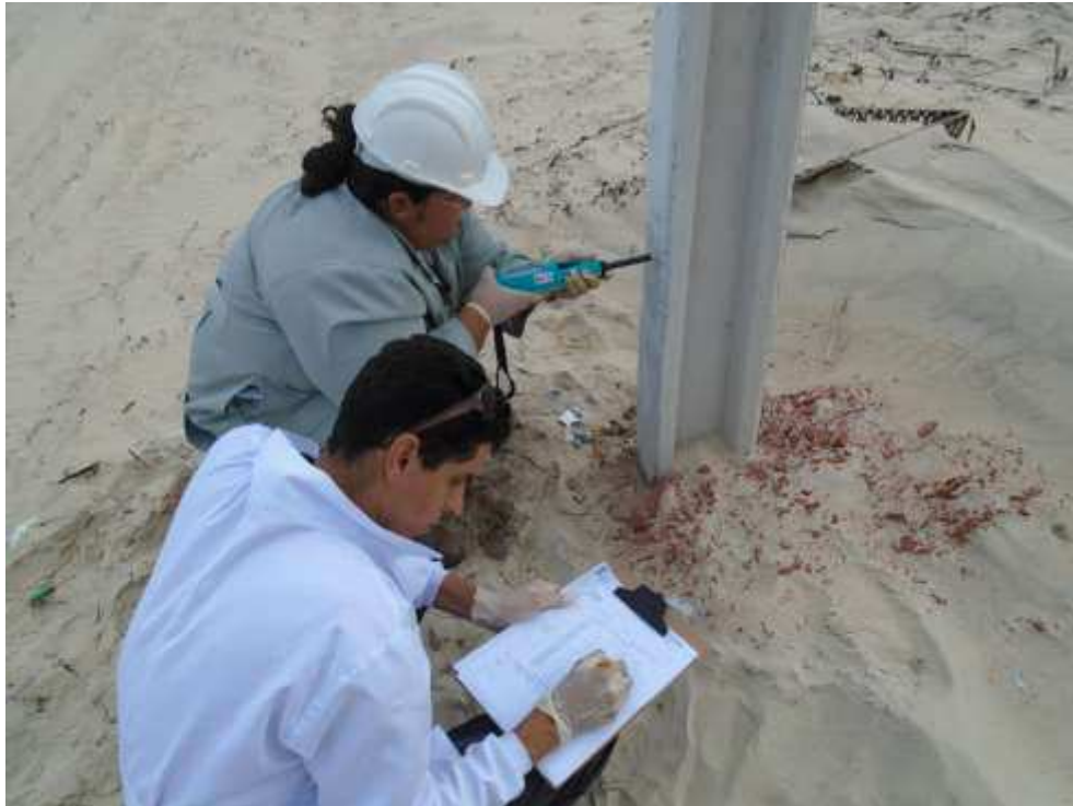
Figura 3-Execução do ensaio não destrutivo de esclerômetria.
