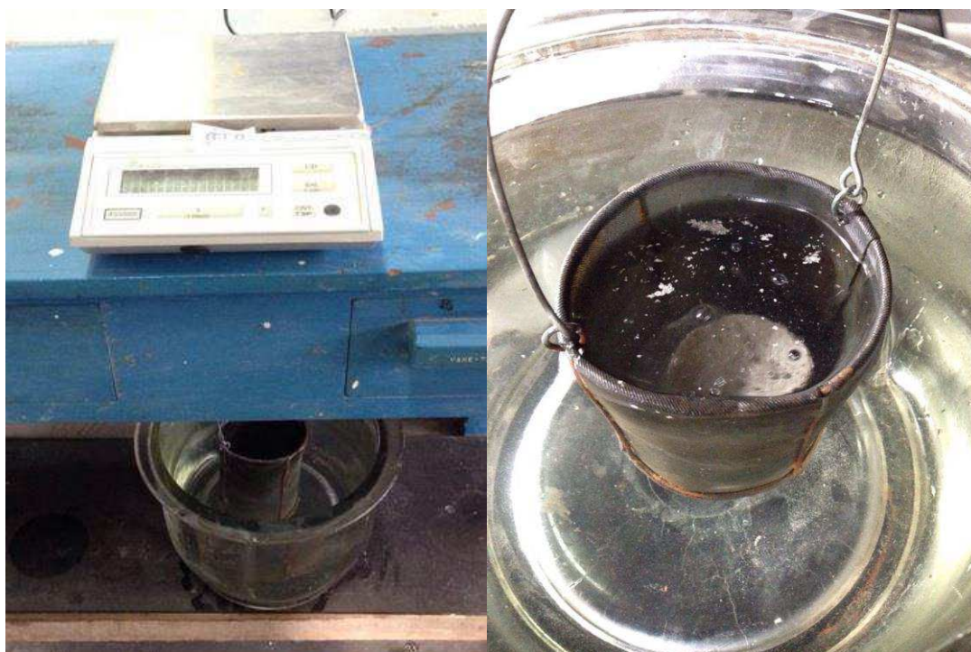
Figura 22: Balança de precisão (a) e dispositivo para pesagem de amostras submersas (b).
