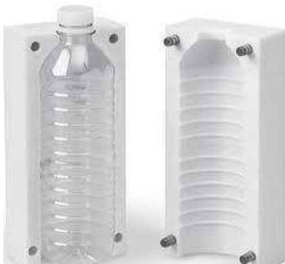
Figura 14: Molde para pré-forma de garrafa PET.
