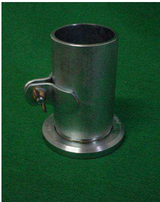
Figura 20: Molde para corpos de prova de argamassas (50x100 mm).
