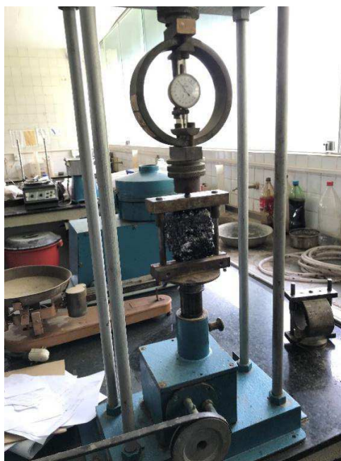
Figura 26: Prensa utilizada para os Ensaio de Estabilidade Marshall e Resistência a Tração
