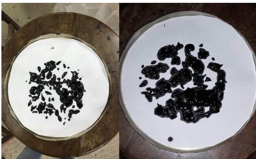
Figura 28: Escorrimento da mistura sem adição da fibra à 150°C e 165°C, respectivamente
