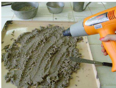
Figura 17: Amostra de agregado miúdo durante secagem
