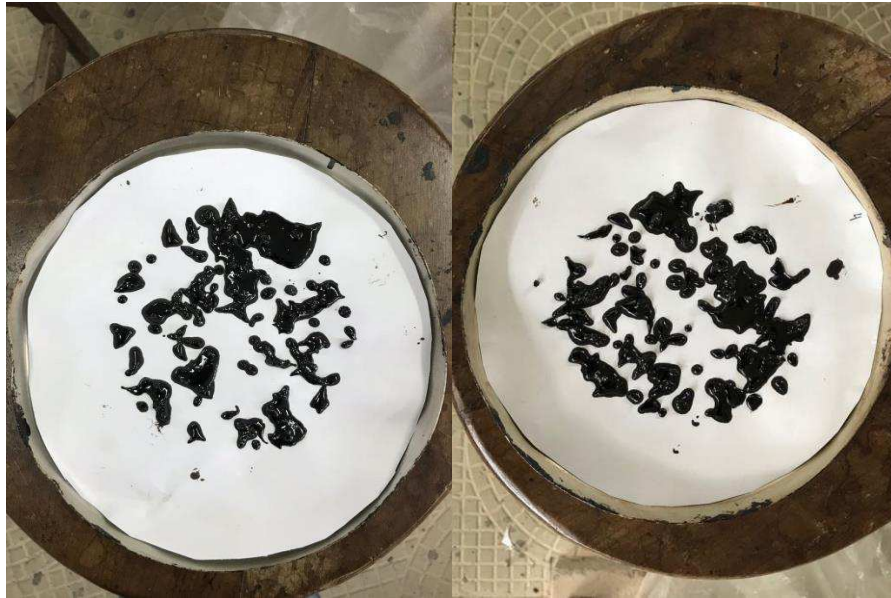
Figura 29: Escorrimento da mistura com 0,1% de fibra à 150°C e 165°C, respectivamente
