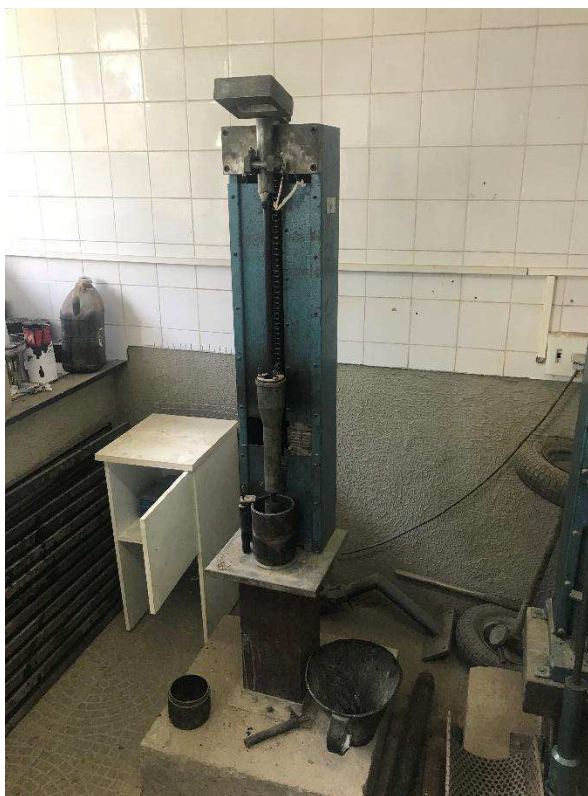
Figura 21: Equipamento Utilizado para compactação Marshall
