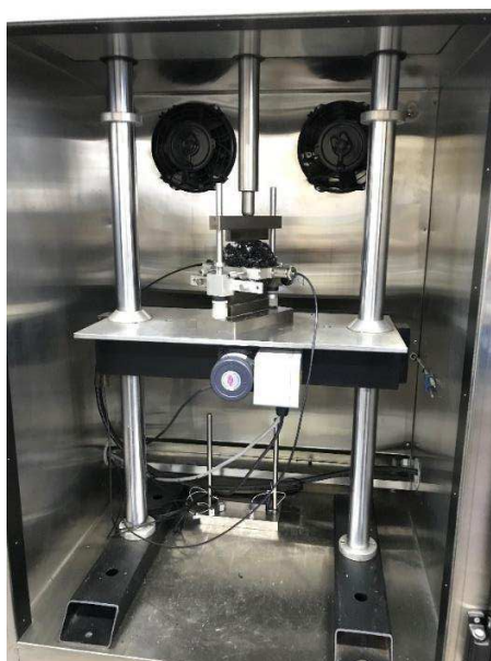
Figura 27: Equipamento utilizado para o ensaio de modulo de resiliência – LEP/UFCG
