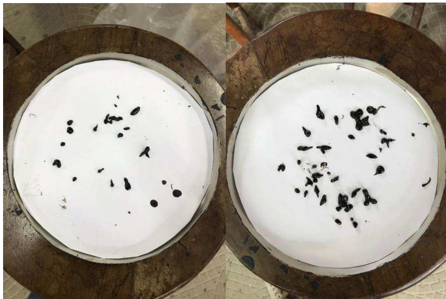
Figura 30: Escorrimento da mistura com 0,3% de fibra à 150°C e 165°C, respectivamente
