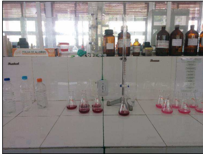
Figura 13 - Ensaio de dureza total e dureza relacionada ao cálcio em andamento
