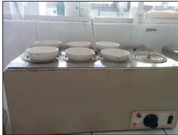
Figura 14 - Fase de evaporação do ensaio de Sólidos Totais Dissolvidos
