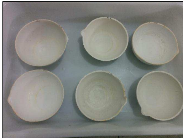
Figura 15 - Cápsulas com resíduos após evaporação no ensaio de Sólidos Totais Dissolvidos
