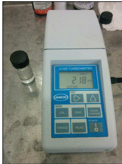
Figura 11 - Ensaio de Turbidez em andamento
