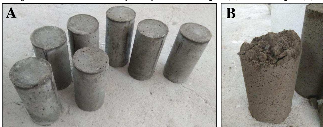
Figura 11 – Desmolde dos corpos de prova sem serragem (A) e com serragem (B).
