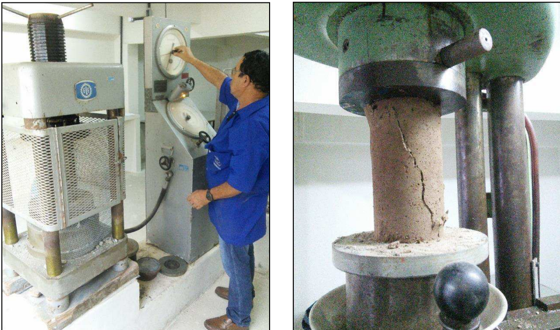
Figura 19 – Ensaio de compressão axial realizado nos corpos de prova.
