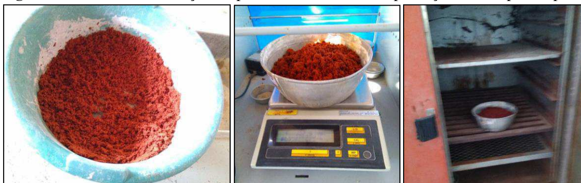
Figura 16 – Ensaio de absorção do pó de serra utilizado na produção dos corpos de prova.
