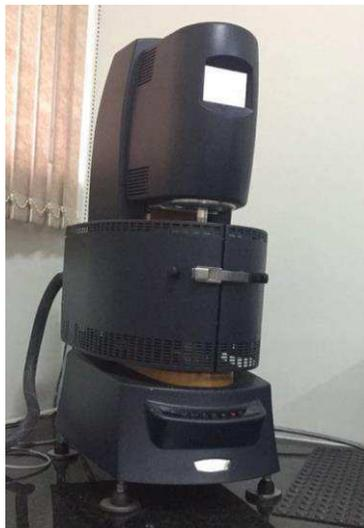
Obtem-se, através desse equipamento, o módulo complexo de cisalhamento ( $G^*$ ) e o ângulo de fase ( $\delta$ ) a temperaturas e frequências de carregamentos desejados. O reômetro possui alta sensibilidade, alto controle da temperatura e taxa de deformação, obtendo assim resultados com uma maior precisão.
