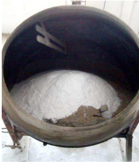
Figura 15 – Material na betoneira após a pesagem.
