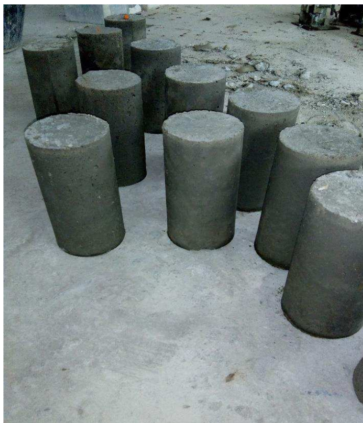
Figura 18 – Desmolde dos corpos de prova.
