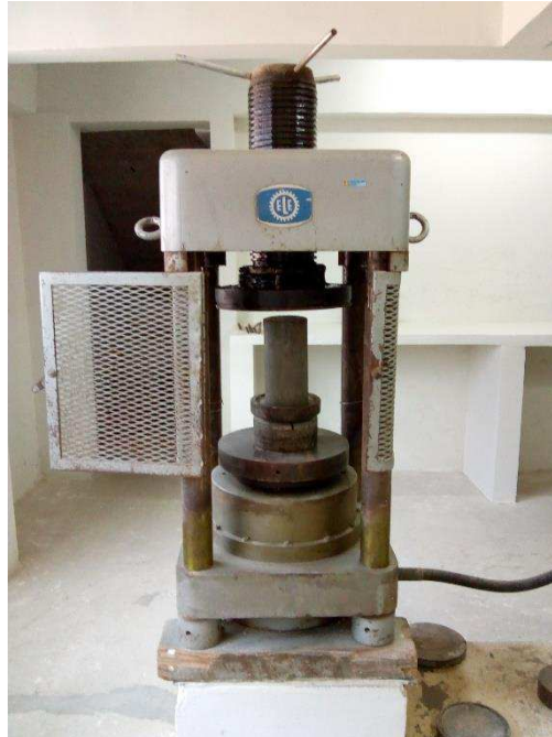
Figura 25 – Corpo de prova para o ensaio de compressão simples.
