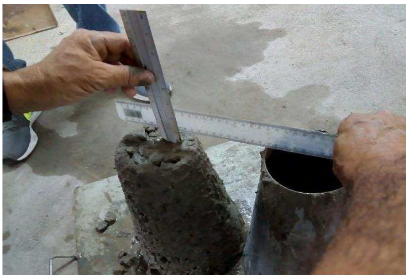
Figura 14 – Abatimento do tronco do cone.
