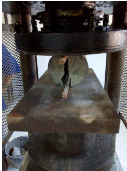
Figura 28 – Corpo de prova após a realização do ensaio de compressão.
