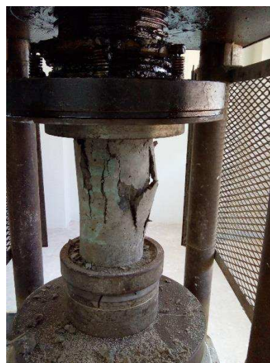
Figura 26 – Corpo de prova após a realização do ensaio de compressão.
