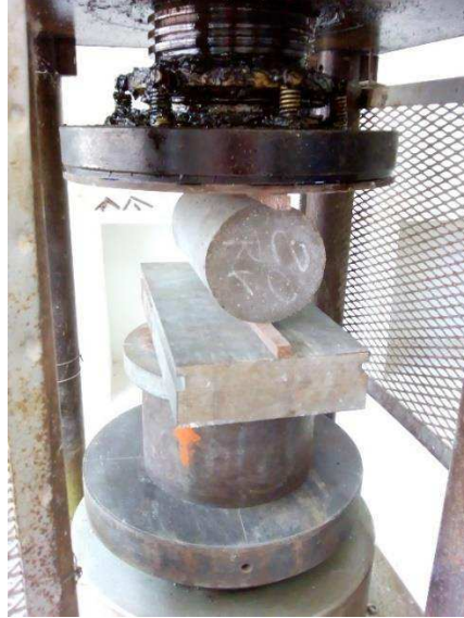
Figura 27 – Corpo de prova para o ensaio de tração por compressão diametral.
