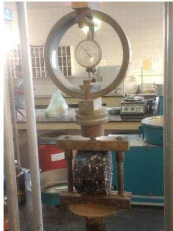
Figura 20 – Equipamento para ensaio RT – Prensa mecânica
