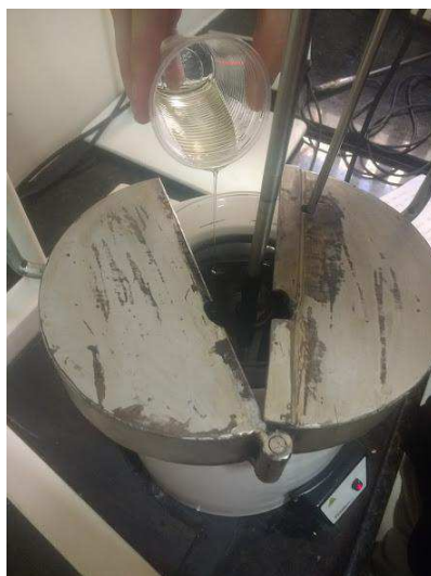
Figura 13 - Adição do óleo no agitador mecânico
