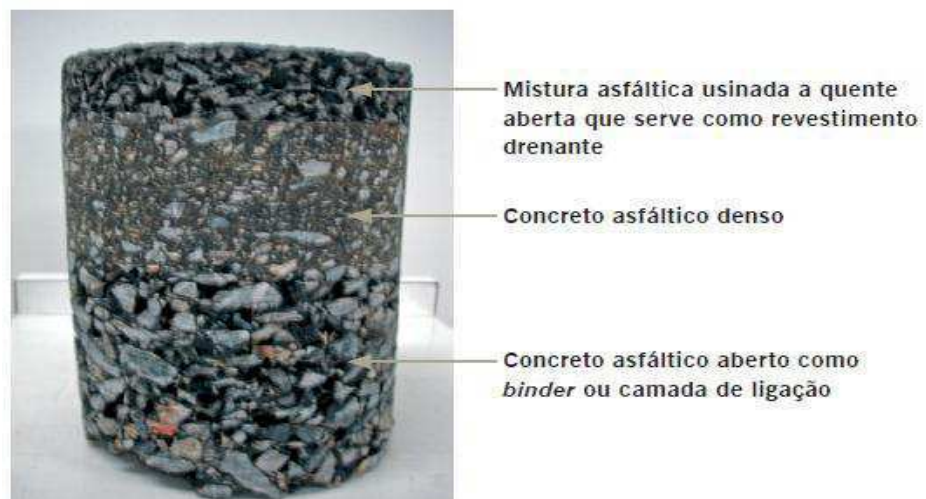
Figura 3 - Corpo de prova com as camadas de revestimento utilizadas
