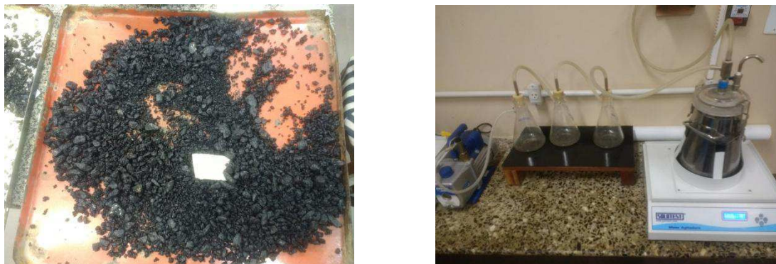
Figura 18 – Etapas Rice Test: (a) bandeja com agregados+CAP soltos; (b) aparelho de Rice
