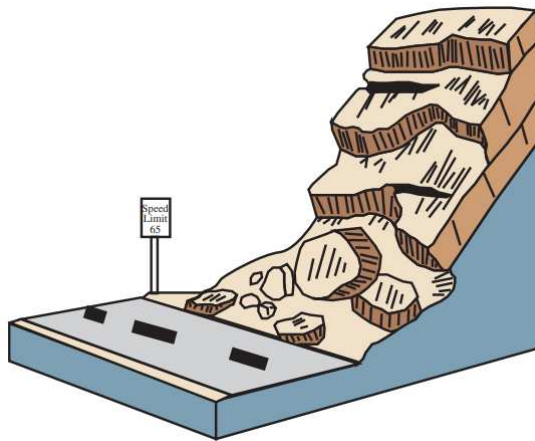
Figura 3: Representação da ocorrência do deslizamento de blocos de rocha
