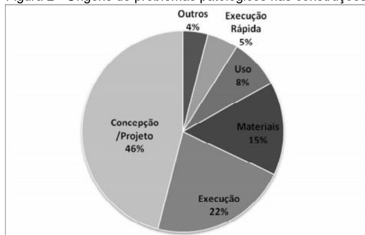
Figura 2 - Origens de problemas patológicos nas construções.
