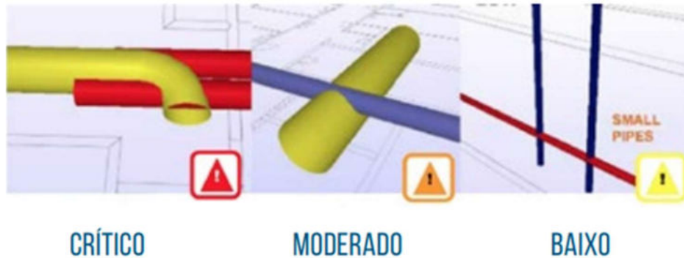
Figura 10 - Classificação automática de interferências geométricas, pelo Solibri.
