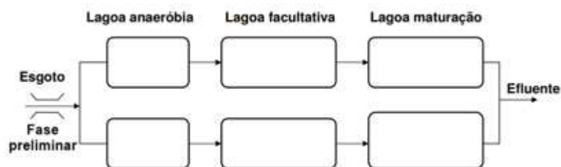
Figura 4 - Esquema de funcionamento das lagoas da fase secundária
