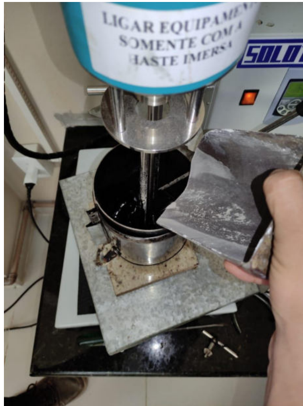
Figura 18 - Processo de formação do mástique asfáltico
