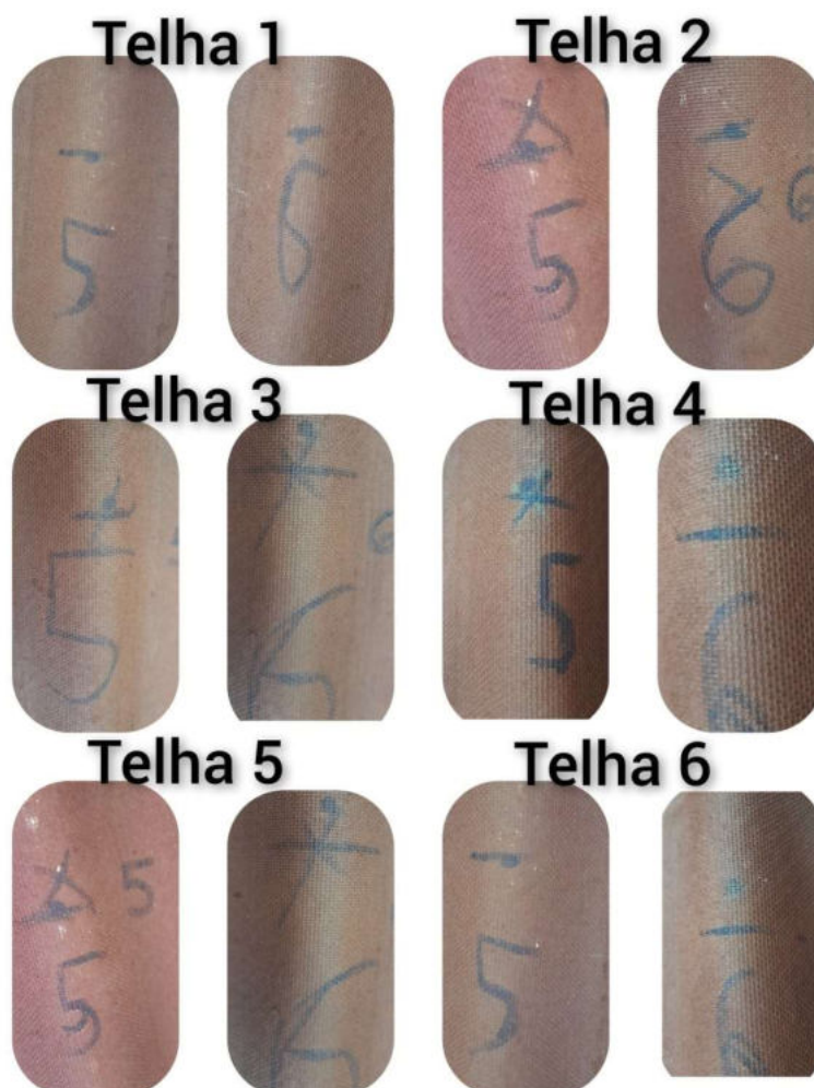
Figura 3.20: Região impactada para energia de 2,5 J, H = 3,80 m, corpo de prova 2.
