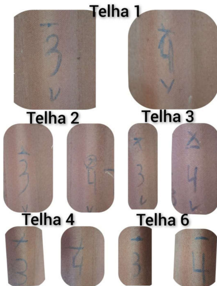
Figura 3.19: Região impactada para energia de 1,5 J, H = 2,30 m, corpo de prova 2.
