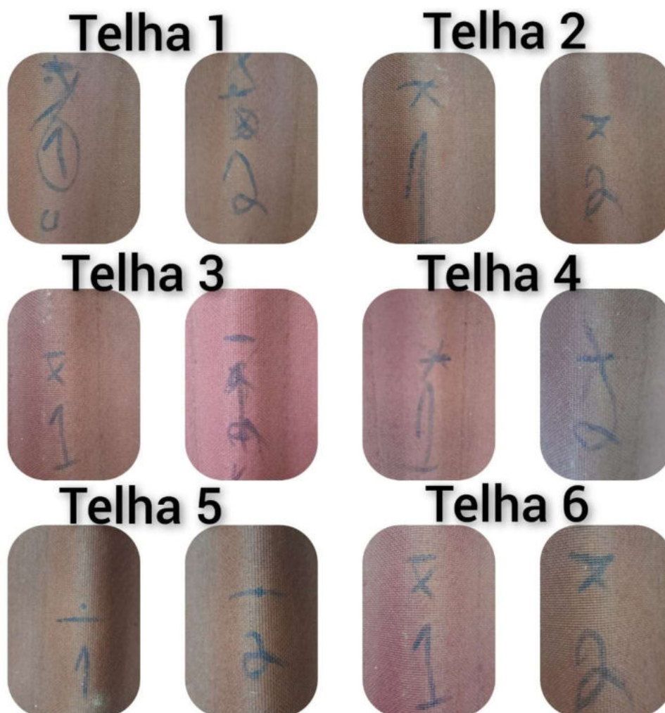
Figura 3.18: Região impactada para energia de 1,0 J, H = 1,50 m, corpo de prova 2.
