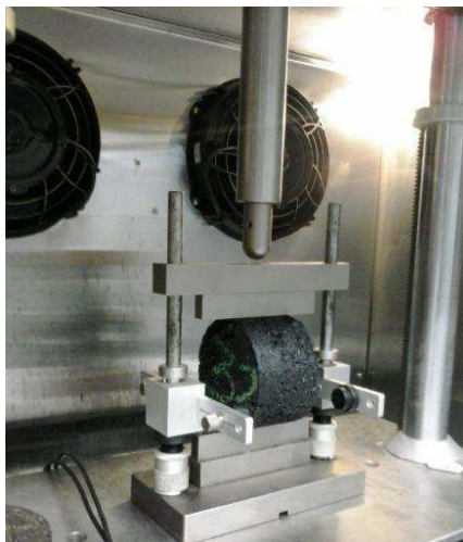
Figura 7 - Ensaio de fadiga por tração indireta por compressão diametral
