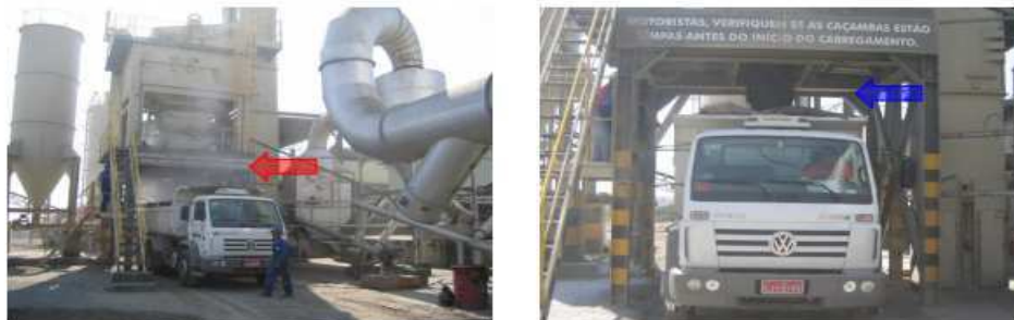
Figura 2- Diferença de fumos liberados pela mistura a quente e pela mistura morna, a esquerda e a direita, respectivamente
