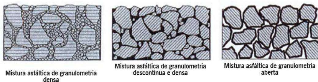
Figura 2 - Ilustração dos três tipos de distribuição granulométrica das misturas asfálticas.
