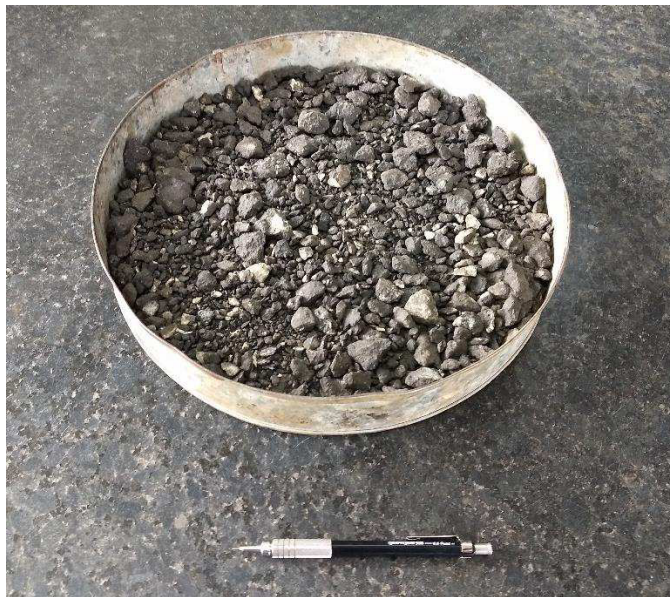
Figura 3 - Amostra de resíduo fresado obtido de fresagem de trecho da BR-230.
