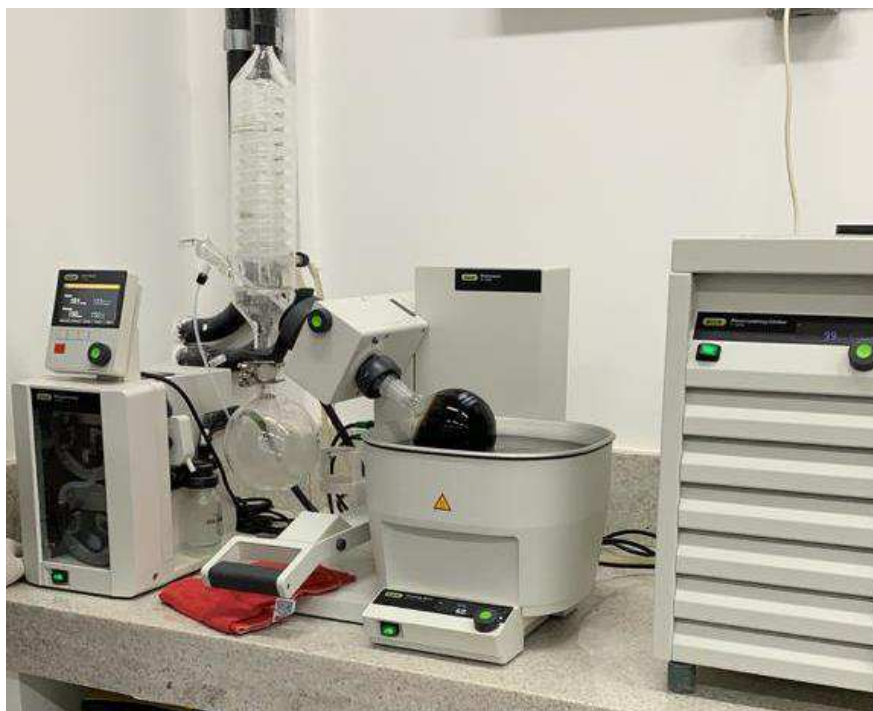
Figura 21 – Ligante recuperado na rotoevaporação e estufa a vácuo
