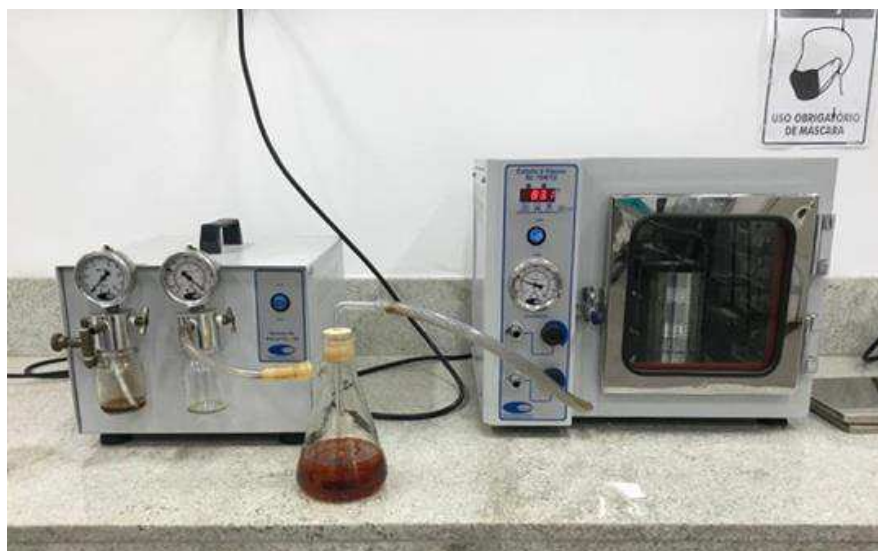
Figura 21 – Ligante recuperado na rotoevaporação e estufa a vácuo
