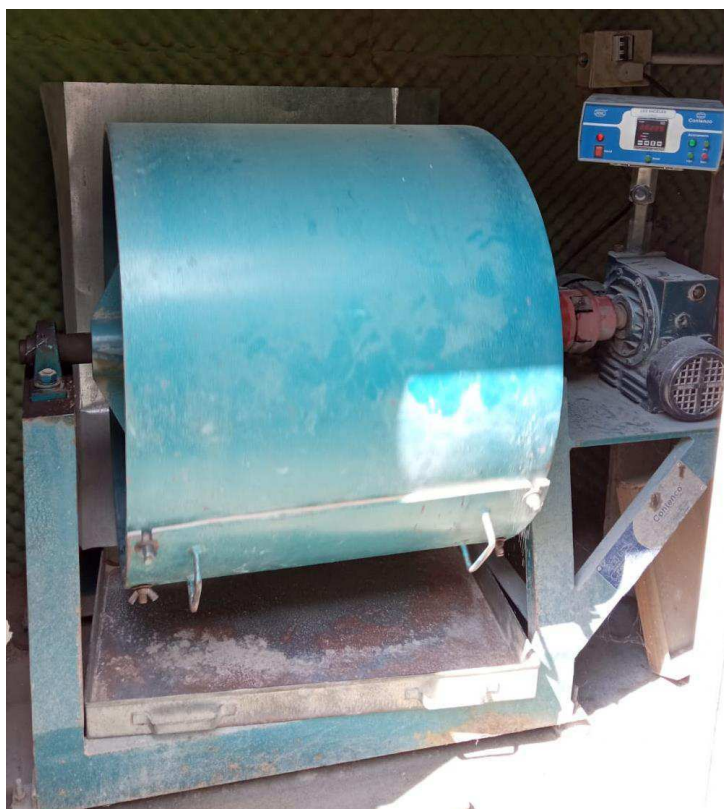
Figura 34 – Aparelho de Abrasão Los Angeles
