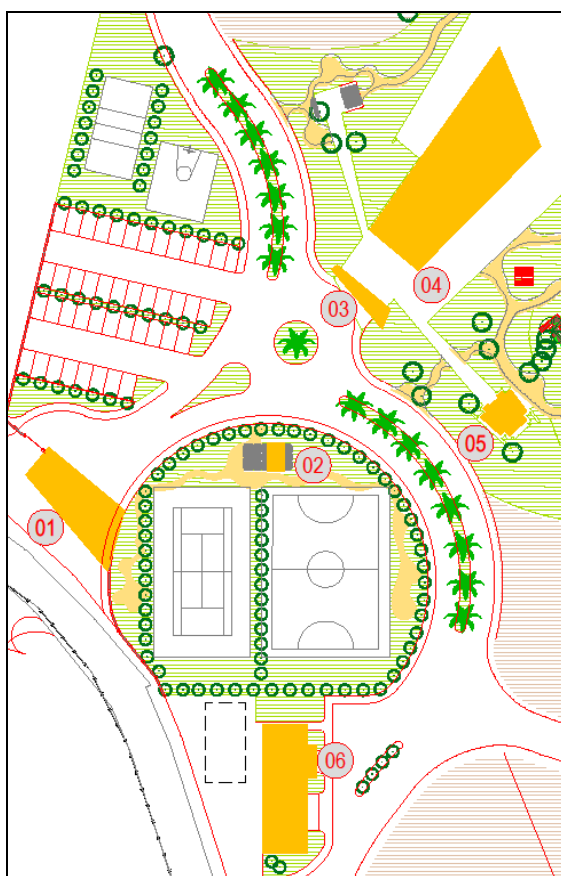
Figura 9 - Áreas de captação de água da chuva.
